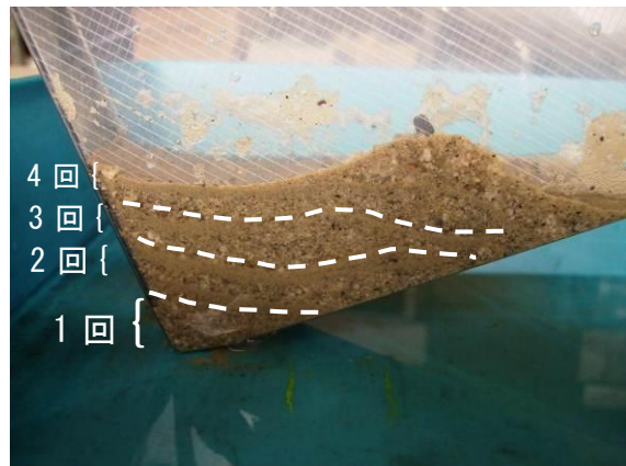
図 1 4 堆積した土砂の様子③
