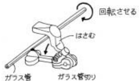
ガラス管の末端処理。
